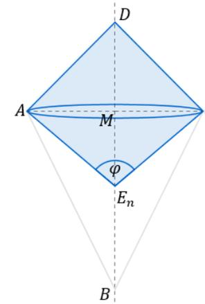
$$V_{\text{Gesamt}} = V_{\text{oberer Kegel}} + V_{\text{unterer Kegel}}$$
